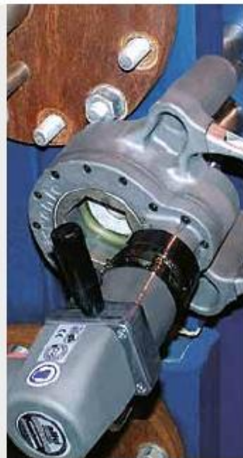
Изображение выше: Теплообменники Альфа Лаваль. Картинки справа: alkitronic® с CLS-SG и RCL в операции на пластинчатые теплообменники.
